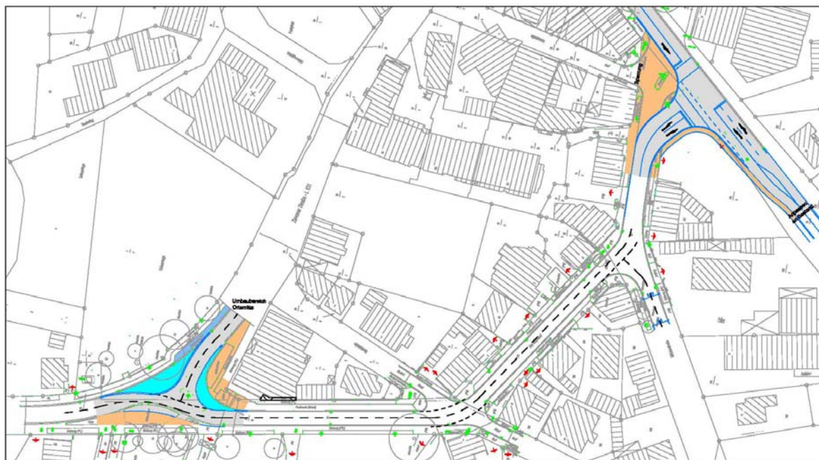
Abb. 11: Vorschlag zum verkehrssichernden Ausbau der Knotenpunkte
